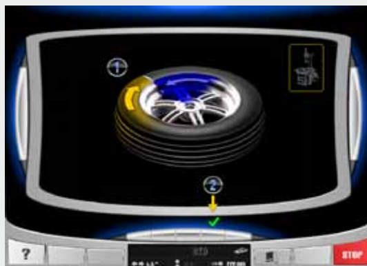
Radial and lateral wheel run-out Excentricidad radial y lateral de la rueda
