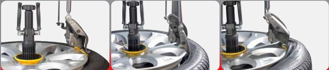
Top bead demounting procedure Procedimiento de desmontaje del talón superior
